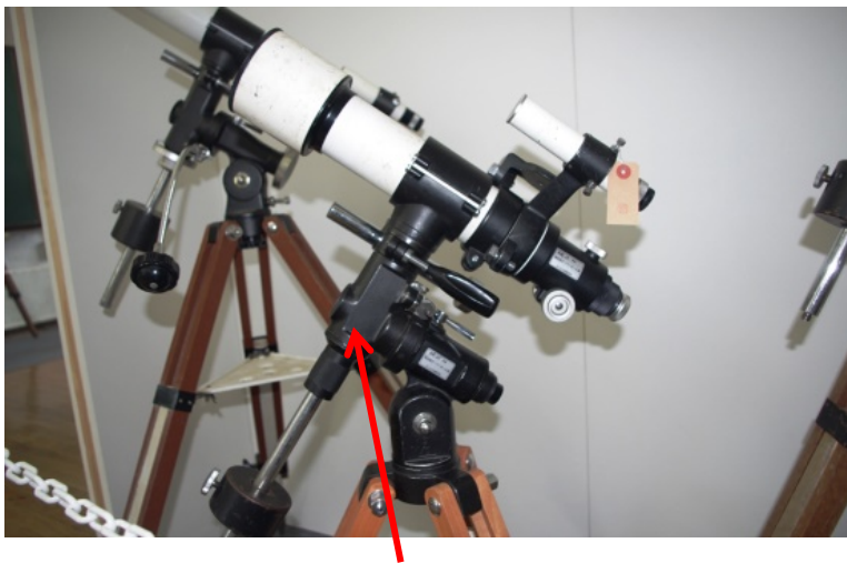
極軸望遠鏡は赤経軸に内蔵されている
